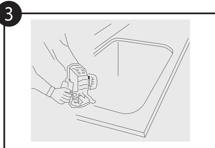
用修边机，锉刀和砂纸修平切口边缘，修出所需圆角。**注意：台面开孔时，请使用沥水板等配件作参考进行调整，以达到最佳使用效果。**
