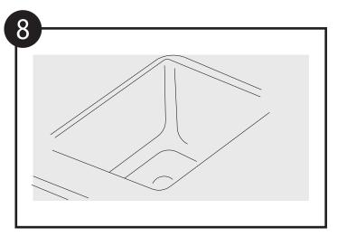
清除台面上的粘胶,用湿布或海棉和温和的清洁剂去除厨盆上的 任何油渍和手印,可掺入一些磨料,轻轻擦洗。安装完毕。
