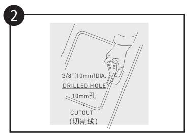
在切割线内侧钻一个直径为3/8"(10mm)的孔,用以放入切割锯的锯条,沿着所画的切割线切割出厨盆的位置。切割完时,请扶住切除部分以免切割口破裂,用砂纸打平切口处。在安装紧固前,把厨盆放入切口内用以检查切口大小入四角位置是否合适。
