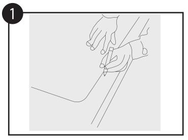
将您的厨具台面清洁干净,把所提供的开孔板放在厨具台面需要安装水槽的合适位置上。按住开孔板,用记号笔按开孔板台下安装开孔画线。**注意:不要用擦不掉的记号笔。**
