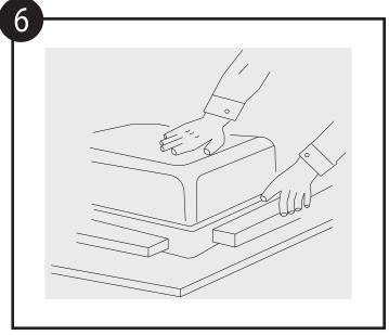
在大理石条上涂上复合胶,将它们粘贴在厨盆四周边缘,并加压重,保证石条压住盆边3/8-1/2英寸(10-12mm)。
