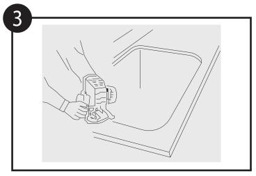
用修边机,锉刀和砂纸修平切口边缘,修出所需圆角。
