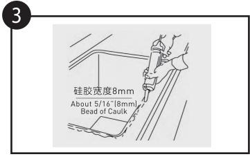
从轮廓线处填入透明的硅胶,胶水宽度为5/16"(8mm),硅胶需连续铺满整个轮廓以保证台面封水)。
