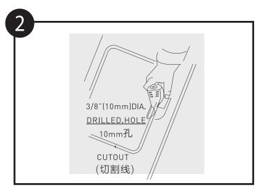
在切割线内侧钻一个直径为3/8"(10mm)的孔,用以放入切割锯的锯条,沿着所画的切割线切割出厨盆的位置。切割完时,请扶住切除部分以免切割口破裂,用砂纸打平切口处。在安装紧固前,把厨盆放入切口内用以检查切口大小入四角位置是否合适。
