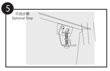
可选步骤:如果石槽没有挂钩,可直接跳过此步骤。如果石槽带有挂钩,将紧固件从中间开始向两边逐个用手拧紧。 注:如有需要,紧固件下面可根据台面板厚度增加适当厚度的木板,达到紧固效果。
