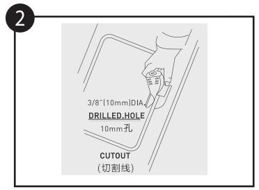
拿开开孔板。在切割线内侧钻一个直径为3/8英寸(10mm)的孔 ,用以放入切割锯的锯条。沿着所划的切割线,切割出厨盆安装 口。在切割完时,请扶住切割部分以免切割口爆裂。
