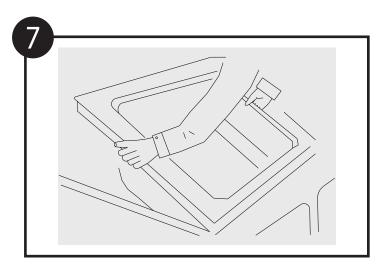
粘结牢固后,将装好厨盆的台面翻转,并安装在橱柜上。
