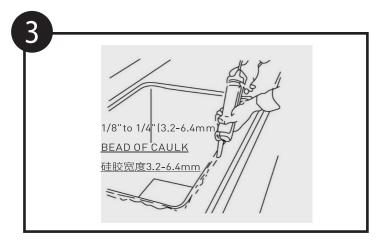
从轮廓线处填入透明的硅胶,胶水宽度为1/8"-1/4"(3.2-6.4mm),硅胶需连续铺满整个轮廓以保证台面封水)。
