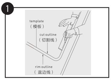
将开孔板放置到要安装位置。**小心:明确开孔的准确位置。沿开 孔板台上安装线边沿画线,不要使用擦不掉的记号笔。**
